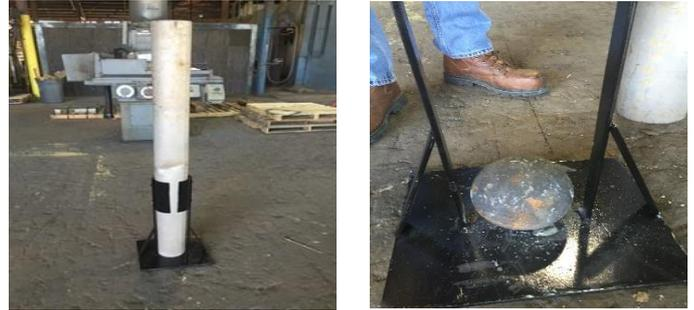
Figura 1: Pruebas en laboratorio para impacto de diferentes tamaños de bolas contra mineral
